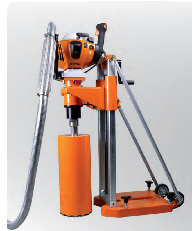
KB150 mit STIHL-Benzinmotor 2,8 kW (3,8 PS) 300 min -1
