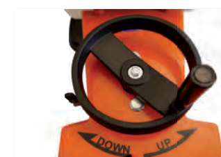
Absenkung über Handrad
