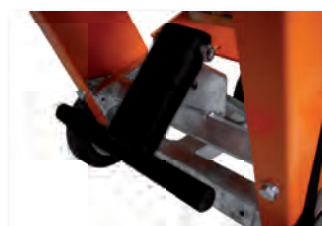
Absenkung über Fusspedal
