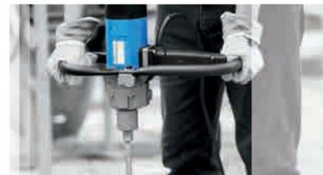
Schnellmischer mit **2-Gang-Getriebe** für zähes Rührgut **bis 100 kg**
