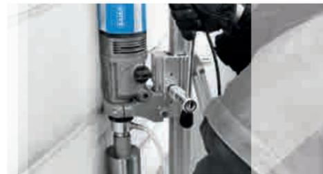
Diamant-Nassbohrmaschine für handgeführte Kernbohrungen in **hartem Stein bis Ø 102 mm**, mit Bohrständer **bis Ø 125 mm**
